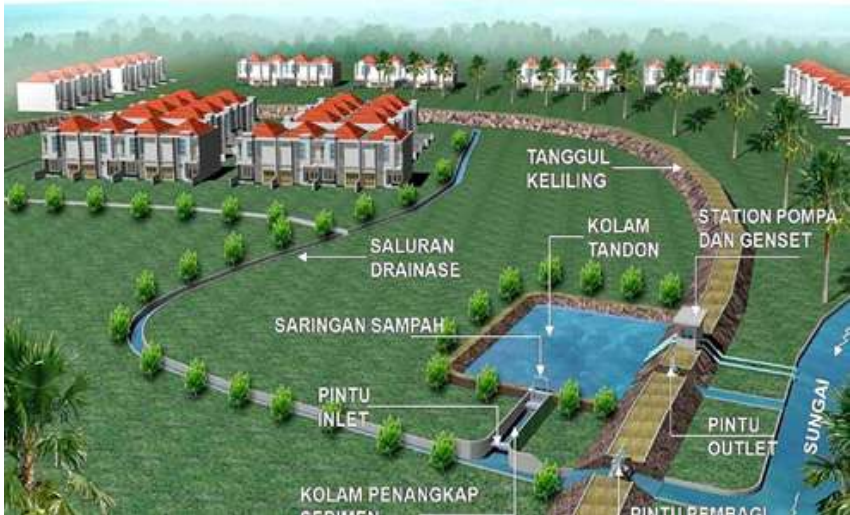
Gambar 6. sistem polder dengan instalasi pompa terletak di dalam badan saluran/sungai
