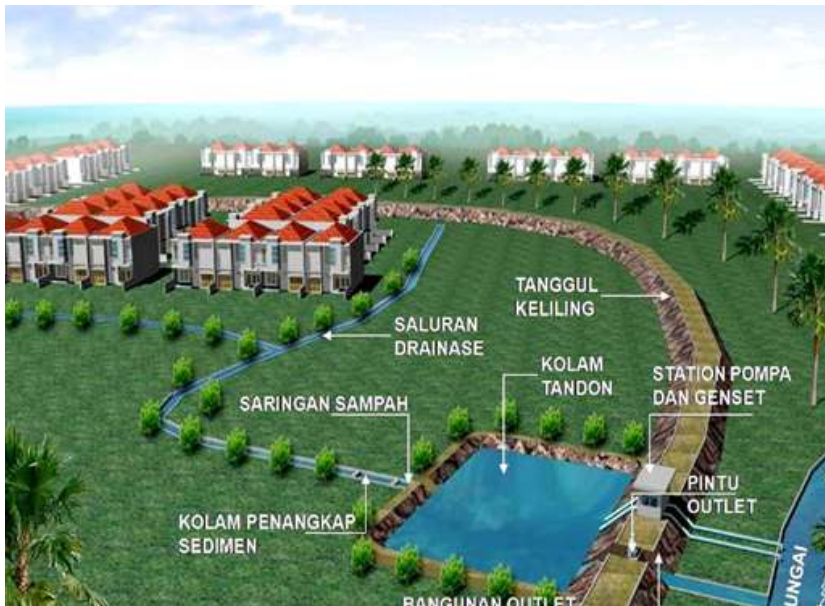
Gambar 8. Sistem polder dengan instalasi pompa terletak di samping badan saluran/sungai
