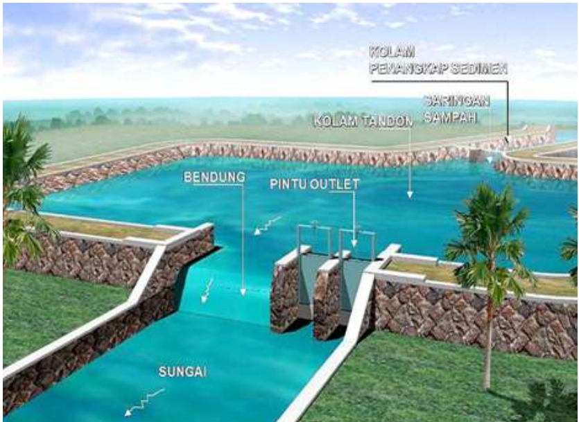
Gambar 5. kolam detensi dan retensi yang terletak di pada badan saluran/sungai
