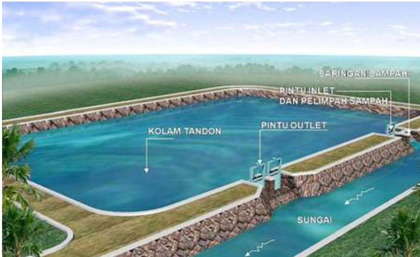
Gambar 3. kolam detensi dan retensi yang terletak di samping badan saluran/sungai
